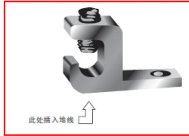
Figura 5 Disegno schematico per la messa a terra del modulo fotovoltaico
